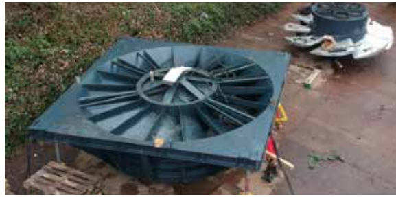
In Auvelais: die Turbine vor der Installation
